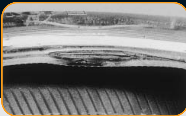
Poškození patky montážním strojem • Bead damage caused by a mounting machine • Повреждение шины монтажным инструментом
