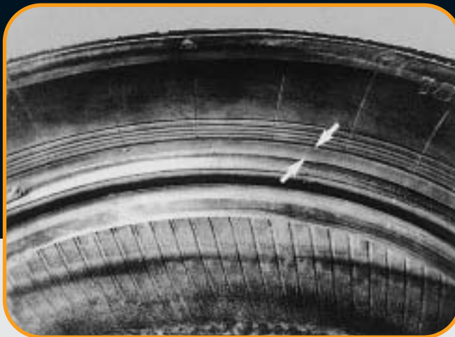
Podélné, široké trhliny v oblasti patky prokazují špatné zacházení • Circumferential, wide indentation in the bead area indicates poor maintenance • Продолговатые, широкие трещины в области борта подтверждают плохое обращение
