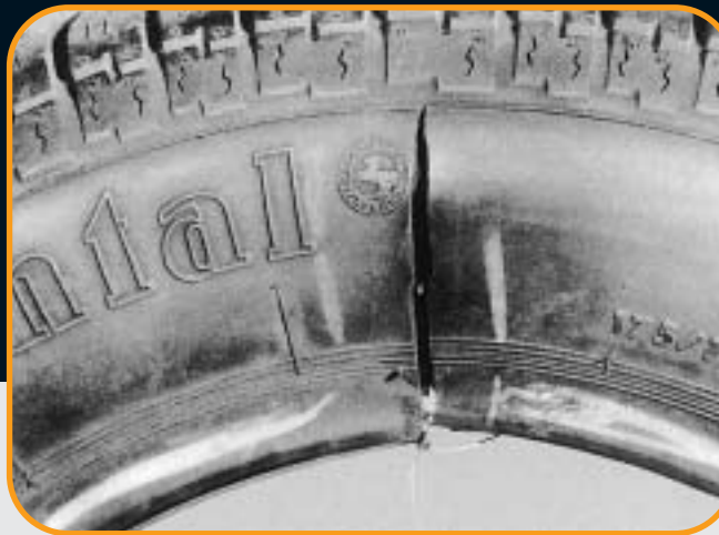
Natržení patky jako výsledek přetlaku během huštění pneumatiky • Ruptured bead as a result of tension during inflation of a tyre • Надрыв борта как результат перекачки шины
